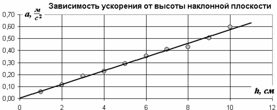
Хорошо известно и легко доказуемо, что при движении тела по наклонной плоскости ускорение пропорционально синусу угла наклона к горизонту. В исследованном случае углы наклона малы, поэтому синус угла наклона примерно равен  $\sin \alpha \approx \alpha = \frac{h}{L}$ , что и объясняет полученную экспериментально зависимость.
